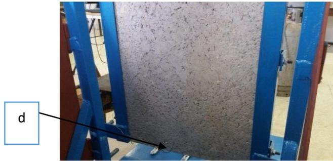
Figure 34 : (d) Thermocouple sur la face arrière
